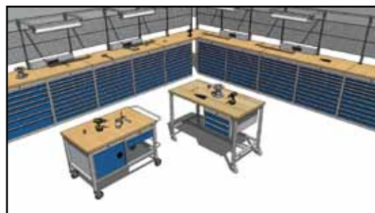
Frei wählbare Arbeitsplatzteilung bei der Fertigung oder Montage durch Mobile Arbeitsplätze
