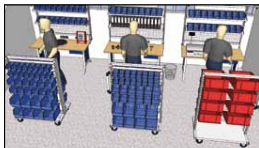
Bereitstellung direkt am Arbeitsplatz durch die Multi-Wagen
