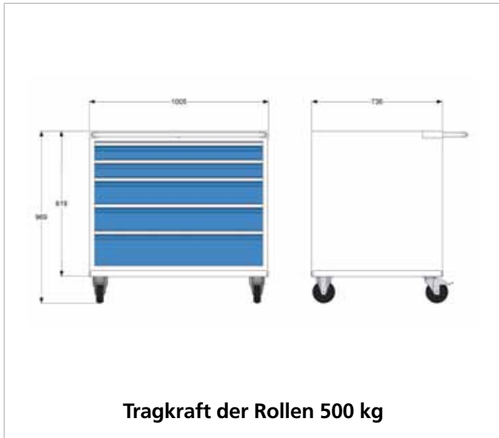
Mobiler Schubladenschrank T736, 5 Schubladen, BLH: 2x 100 mm, 2x 150 mm, 1x 200 mm
