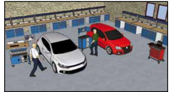
Einsatz diverser Montage- und Prüfplätze in Form von Mobilien in einer Kfz-Werkstatt
