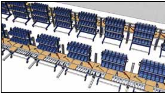
Bestückung durch Workcrafter-Mobile in einer Fertigungsstraße
