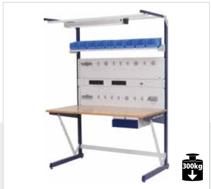
Grundmodul E, Höhe 2070mm, Platte Buche multiplex, Obergestell mit Schiene und Beleuchtung, 2 Lochwände à 302mm, 1 Fachboden 320mm, Energieleiste 4 Steckdosen u. 1x Druckluft, 1 Hängeschublade 100mm / Basic module E, height 2070mm, top multiply, overhead frame with rail and lamp, 2 perforated panels à 302mm, 1 shelf 320mm, 1 electrical passage 4 sockets, 1 compressed air kit, 1 hanging drawer block 100mm / Module de base E, haut. 2070mm, plateaux multiplis, cadre sup. avec rail et lampe, 2 panneaux perforés à 302mm, tablette 320mm, rampe électrique 4 prises et 1 set air comprimé, tiroir suspendu 100mm
