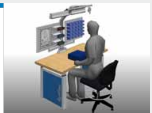
< Stehend arbeiten, großes Werkstück und geringe Arbeitshöhe Standing work - big part and low table Travail debout - grand pièce et table basse
