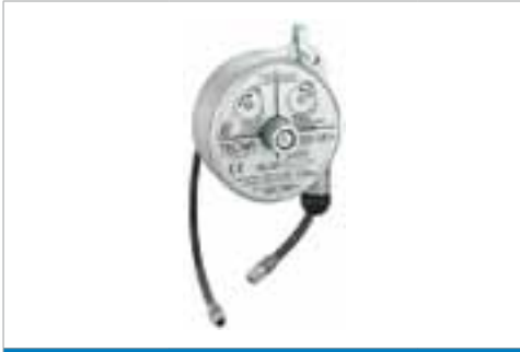
Federzug mit Schlauch, max. 8 bar, 30L/min., beiseitig 1/4", Auszug 1400mm Balancer with tube, max. 8bar, 30l/ min., access 1/4A, length 1400mm Dispositif avec tuyau, max.8p.a., 2x1/4A, long.1400mm
