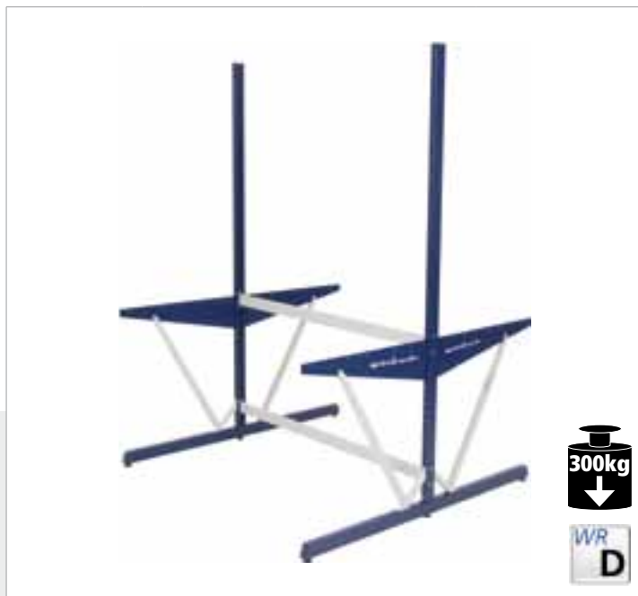
Workraster Grundmodul zweiseitig, je 2 Fußgestelle, Tragsäulen, Traversen, Knotenbleche, Stützen und Plattenträger, t=1460mm / Basic mod. double-sided, 2 off feet, uprights, traverses, junctions plates, supports for top / Module de base bilatéral, Chaque cadre à 2 piètements, traverses, plaques gousset, supports pour panneau
